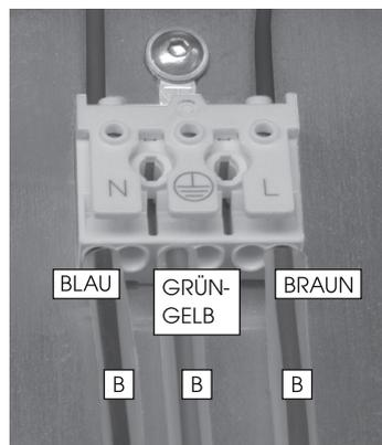
5. Versehen Sie nun alle drei Kabel die in die Leuchte führen mit einem Silikonschlauch **B** aus dem mitgelieferten Montagekit. Die Silikonschläuche schützen die Kabel vor den hohen Temperaturen die in der Leuchte entstehen.
