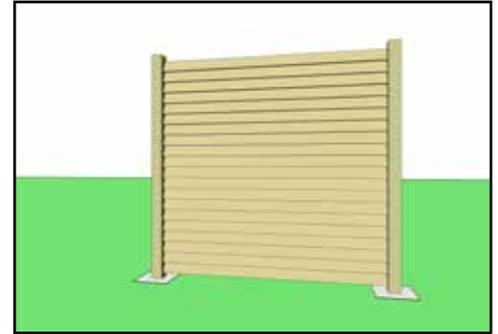
15) Die Füllungsprofile werden anschließend bis auf eine maximale Höhe von 180 cm aufeinandergesteckt.
