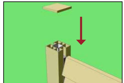
16) Zuletzt werden die Pfostenkappen mit einem PUR Kleber auf den Pfosten befestigt.
