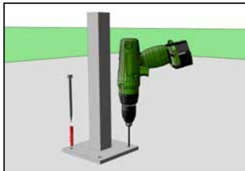
5) Alternativ können bei bauseits vorhandenem Betonfundament oder Mauersockel Konsolen zum Aufschrauben Verwendung finden. Diese werden vom Maß her identisch wie beim Betonieren ausgerichtet und mit einer geeigneten Schrauben-/Dübelkombination befestigt.
