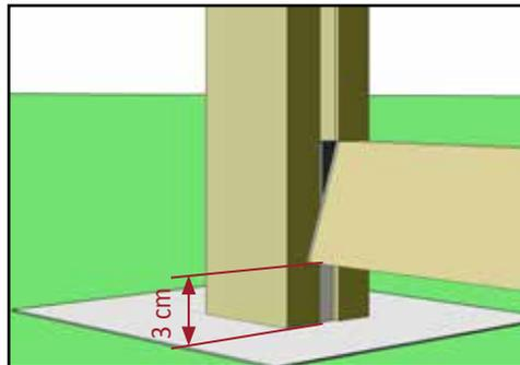
13) Das unterste Füllungsprofil steht auf den Distanzstücken auf und erhält somit eine Bodenfreiheit von ca. 3 cm.
