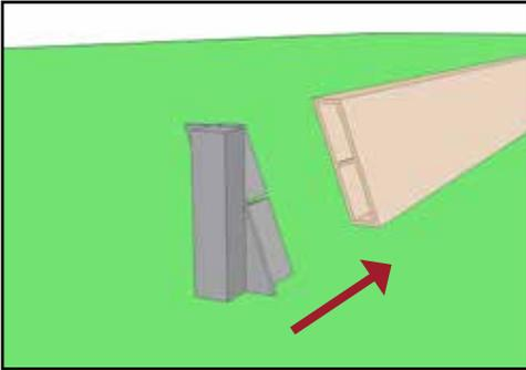
9) Zur Aufnahme der Schräglamellen in den Pfostennuten werden in die Lamellen passende Adapterstücke eingeschoben, um die Schrägstellung der Lamelle zu garantieren. Es ist hierbei darauf zu achten, dass es linke und rechte Adapterstücke gibt.
