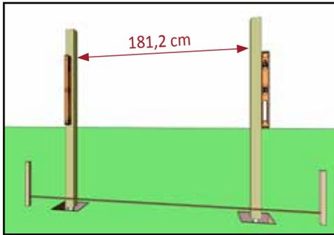
2) Die Pfosten 50 cm tief in die Fundamentlöcher setzen und mit einer Wasserwaage ausrichten (von zwei Seiten, 90° versetzt). Die Pfosten so einrichten, dass der lichte Abstand zwischen den Innenseiten der Pfosten ca. 181,2 cm beträgt. Die Oberkanten der Pfosten mit der Wasserwaage auf die gleiche Höhe ausrichten.
