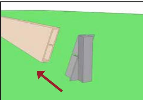
10) Auf der anderen Seite wird das passende Gegenstück eingeschoben. Die jeweils linken und rechten Adapterstücke so einschieben, dass die Aufnahmen, welche in den Pfostennuten eingeführt werden, parallel stehen!
