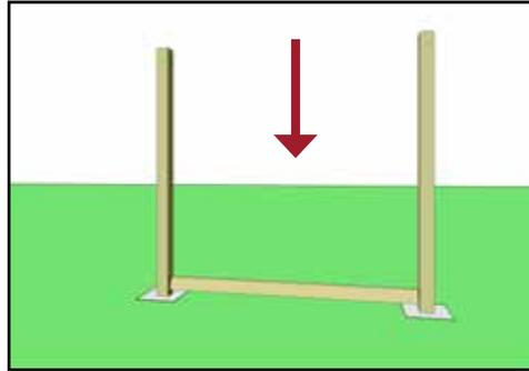
12) Anschließend wird das Lamellenprofil bis auf das Distanzstück heruntergedrückt.
