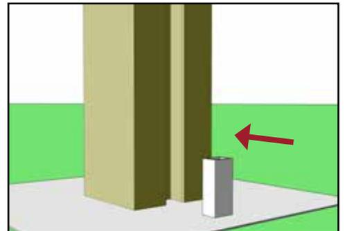
7) Obwohl die Resystaprofile direkt auf dem Untergrund verlegt werden können, empfehlen wir, unter das untere Profilbrett ein jeweils ca. 3 cm langes Stück Aluminiumprofil (Quadratrohr 2 x 1,5 cm) in die Aufnahmenuten einzuschrauben (Bitte das Bohrloch vorbohren). Diese dienen als Distanzstücke unter dem unteren Füllungsprofil. In diesem Fall ist das untere Profilbrett mittig zu unterfüttern, so dass dieses nicht durchbiegt.
