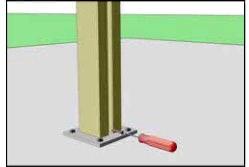
6) Die Pfosten anschließend über die Konsolen stecken und mit zwei Blechschrauben gegenüberliegend, die quer am unteren Pfostenrand eingeschraubt werden, sichern. Löcher bitte vorbohren!
