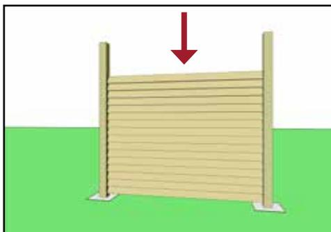
14) Die weiteren Schräglamellenprofile werden nacheinander von oben eingeschoben und durch die eingesteckten Adapterstücke auf dem notwendigen Abstand gehalten. Ein 180 cm hohes Zaunelement besteht aus 20 aufeinander gesteckten Lamellenprofilen.
