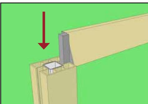
11) Das erste Füllungsprofil mit den eingeschobenen Adapterstücken wird oben mittig zwischen den Pfosten eingesetzt.
