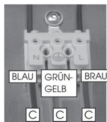
4. Versehen Sie nun alle drei Kabel die in die Leuchte führen mit einem Silikonschlauch **C** aus dem mitgelieferten Montagekit. Die Silikonschläuche schützen die Kabel vor den hohen Temperaturen die in der Leuchte entstehen.
