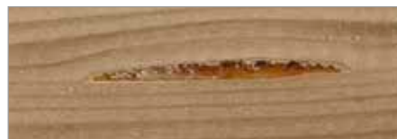
Harzgallen mit Entharzer entfernen
