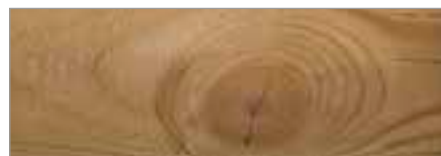
Äste gehören zum Werkstoff Holz
