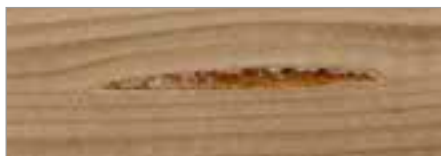
Harzgallen mit Entharzer entfernen
