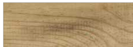
Stockflecken mit chlorhalt. Reiniger entfernen
